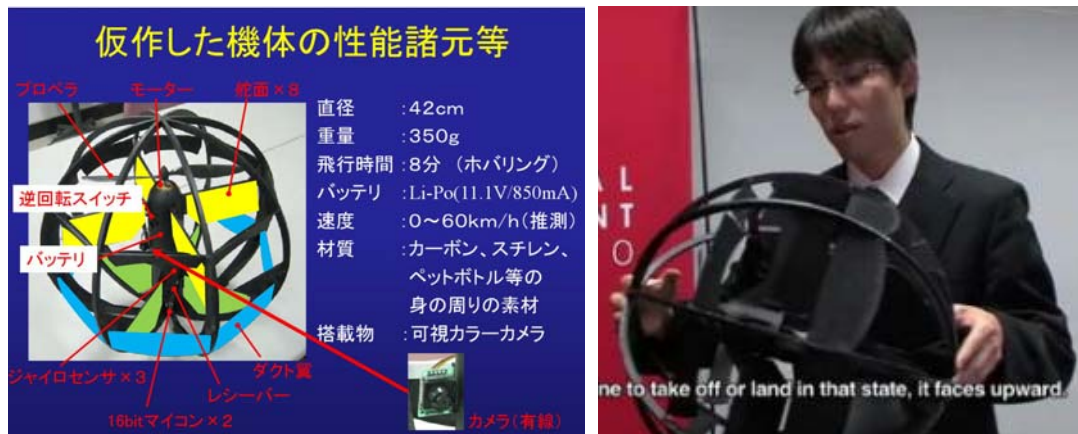
图7 日本人发明的单轴球形飞行器
